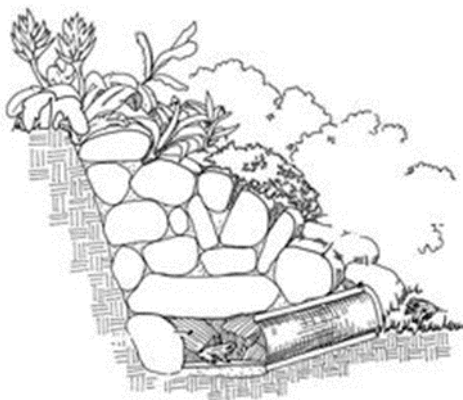
Figure 69 : Schéma de principe d'un abri pour amphibiens / reptiles de type hibernaculum au pied d'un merlon
