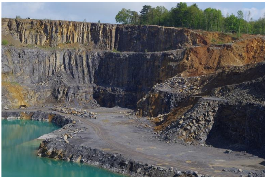
Figure 19 : Vue sur les bancs subverticaux de calcaire givétien sur le front Nord-Ouest de la fosse de la carrière en Mai 2021 (avec les bancs plus terrigènes du Membre de Flohimont sur la droite de la photo)
