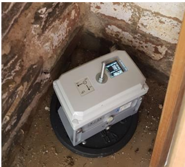
Figure 114 : Géophone installé à la Voie d'Aisne, 2 à Heyd Source : ROOM's
